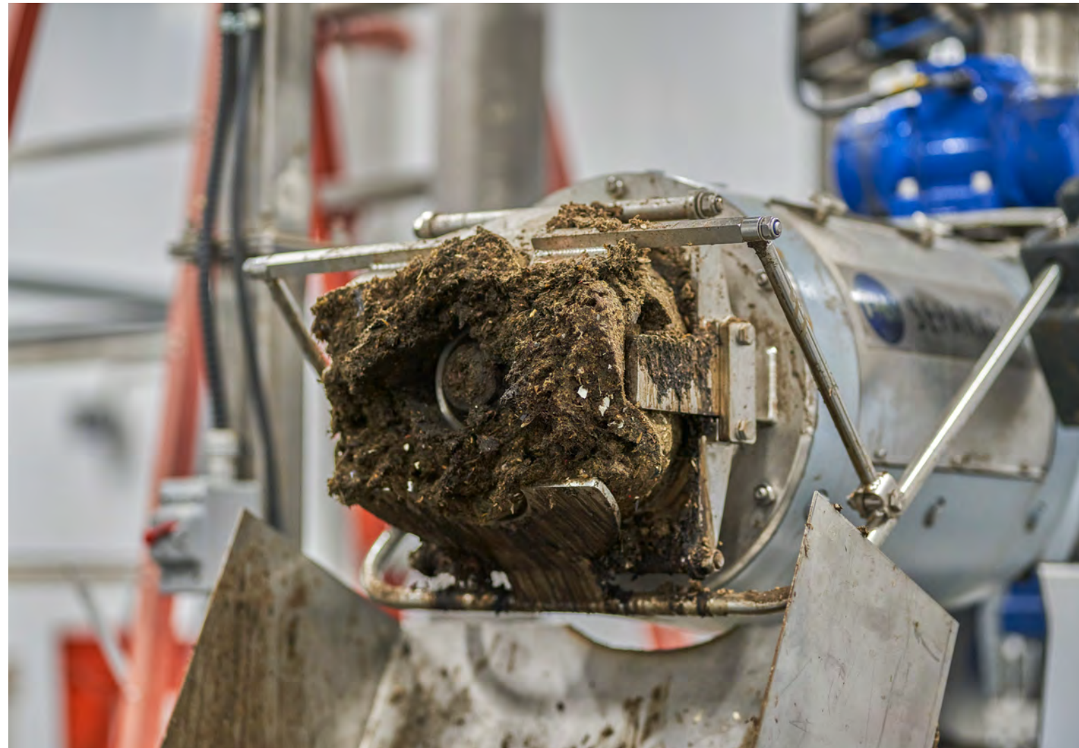
Presse à vis qui presse des contaminants fins
